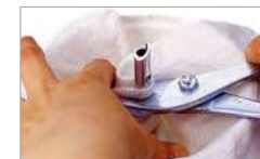
カプリングが非常に堅い場合 カプリングを傷つけないよう布巾などの上からペンチなどで挟むようにして外してください。
